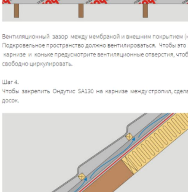
Вентиляционный зазор между мембраной и внешним покрытием (кровлей) - 5 см. Подкровельное пространство должно вентилироваться. Чтобы это происходило в карнизе и коньке предусмотрите вентиляционные отверстия, чтобы воздух мог свободно циркулировать.
