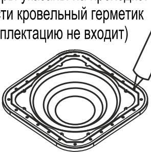
4 Устанавливаем проходной элемент EPDM.
