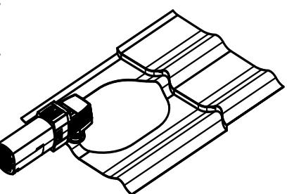
3 Подрезать проходку под необходимый диаметр трубы. Размеры указаны на проходке. Нанести кровельный герметик (в комплектацию не входит)
